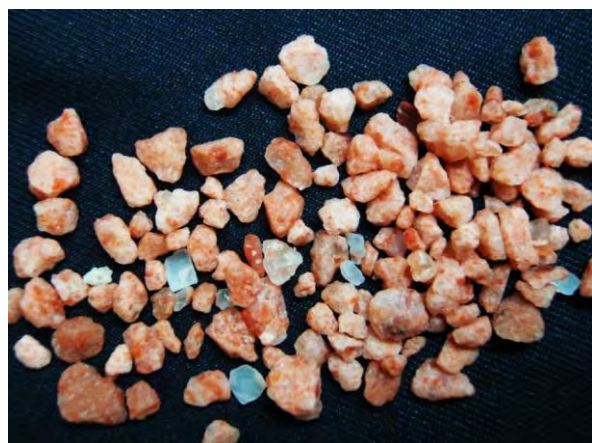
▲ 塩化加里(1), 現物 純品は白色結晶, 原料や製法の違いで着色する.
