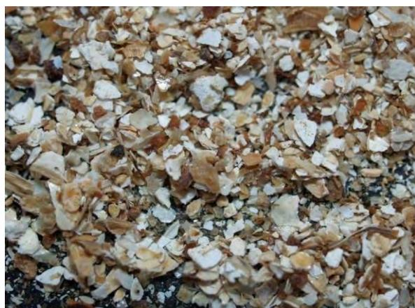
▲ 甲殻類質肥料粉末(1), 実体顕微鏡(10倍)
