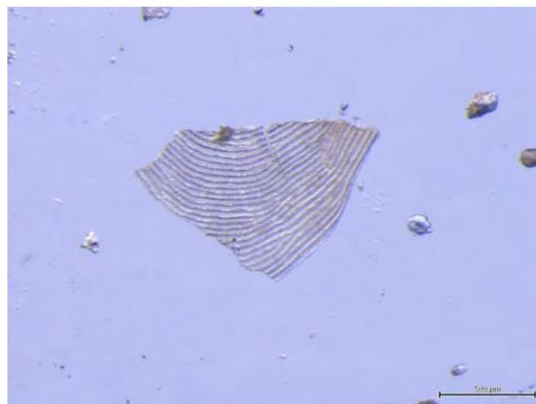
▲ 魚かす粉末(1), 光学顕微鏡(酸処理, 100倍)
