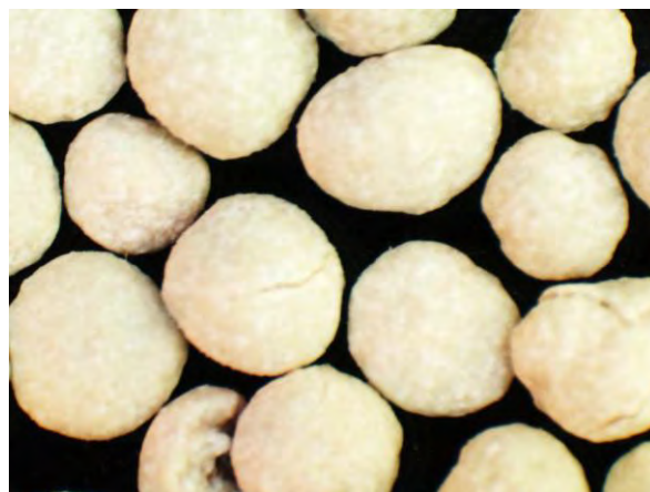
▲ 被覆複合肥料(1), 実体顕微鏡(10倍)
