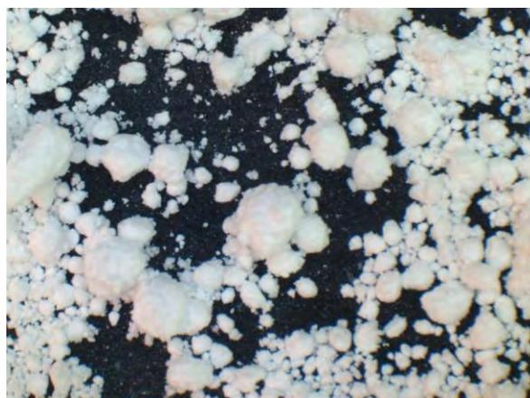
▲ 水酸化苦土肥料(1), 実体顕微鏡(10倍)
