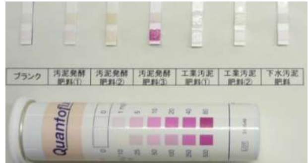
写真 2 流通肥料(汚泥肥料)の試験結果 抽出方法：水による 30 秒間振り混ぜ 試験紙：QUANTOFIX® Nitrate/Nitrite
