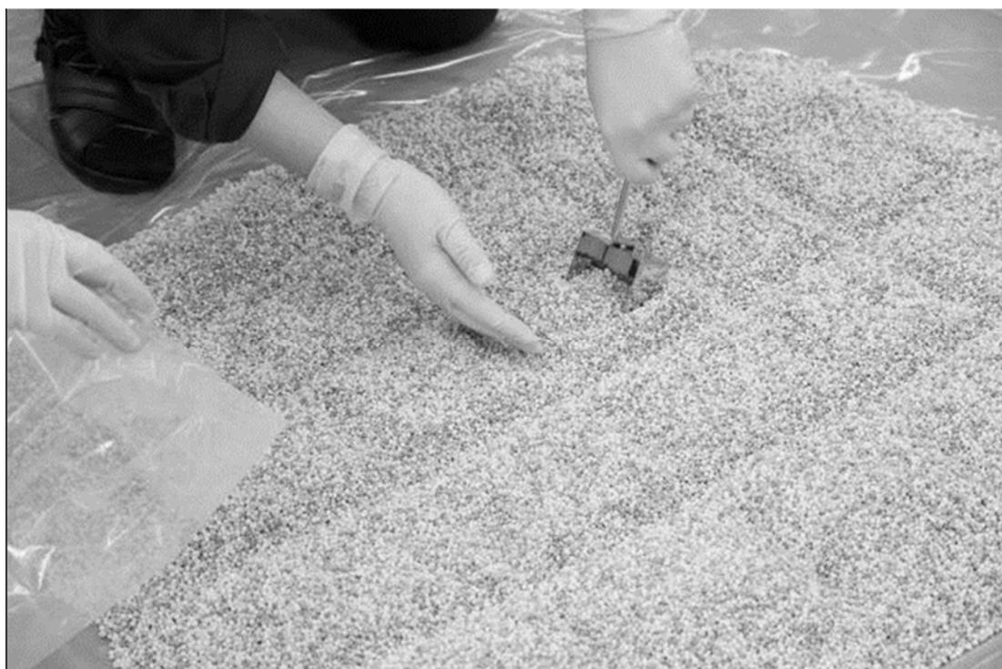
付図 1-3 インクリメントスコップを用いた粉粒状肥料の縮分操作(2)
