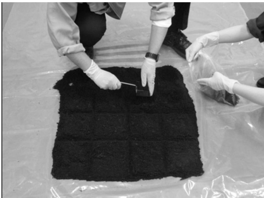
付図 1-5 インクリメントスコップを用いた堆肥等(固形)の縮分操作(2)
