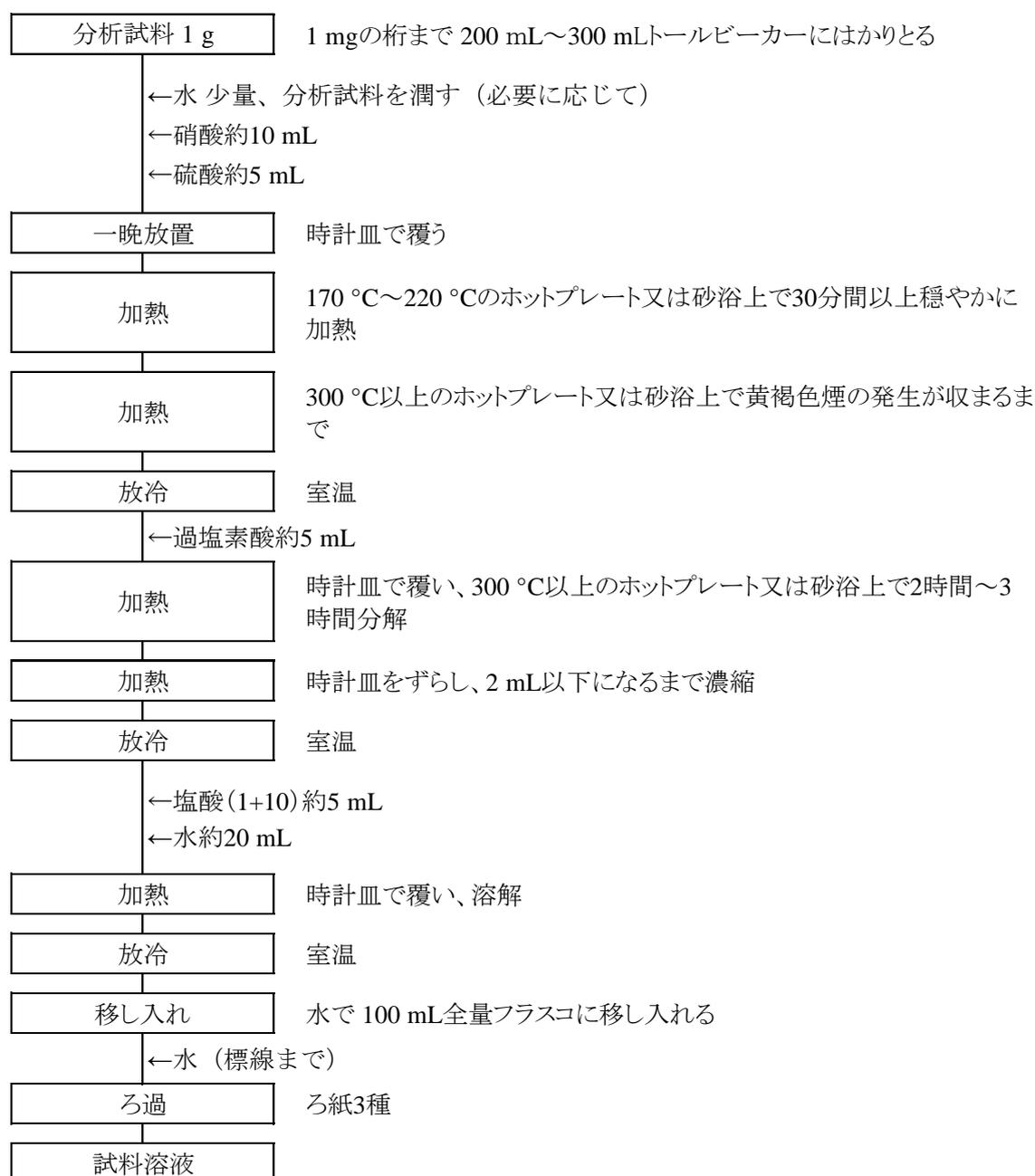
図1 焼成汚泥肥料及び有機物を含まない肥料中のクロム試験法フローシート (抽出操作)
