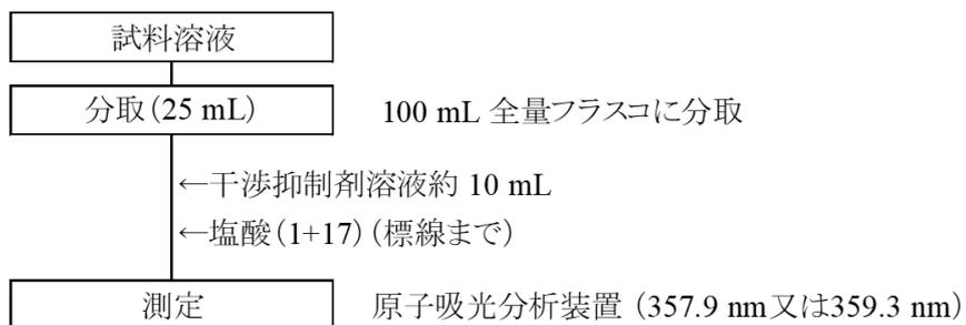
図2 焼成汚泥肥料及び有機物を含まない肥料中のクロム試験法フローシート(測定操作)
