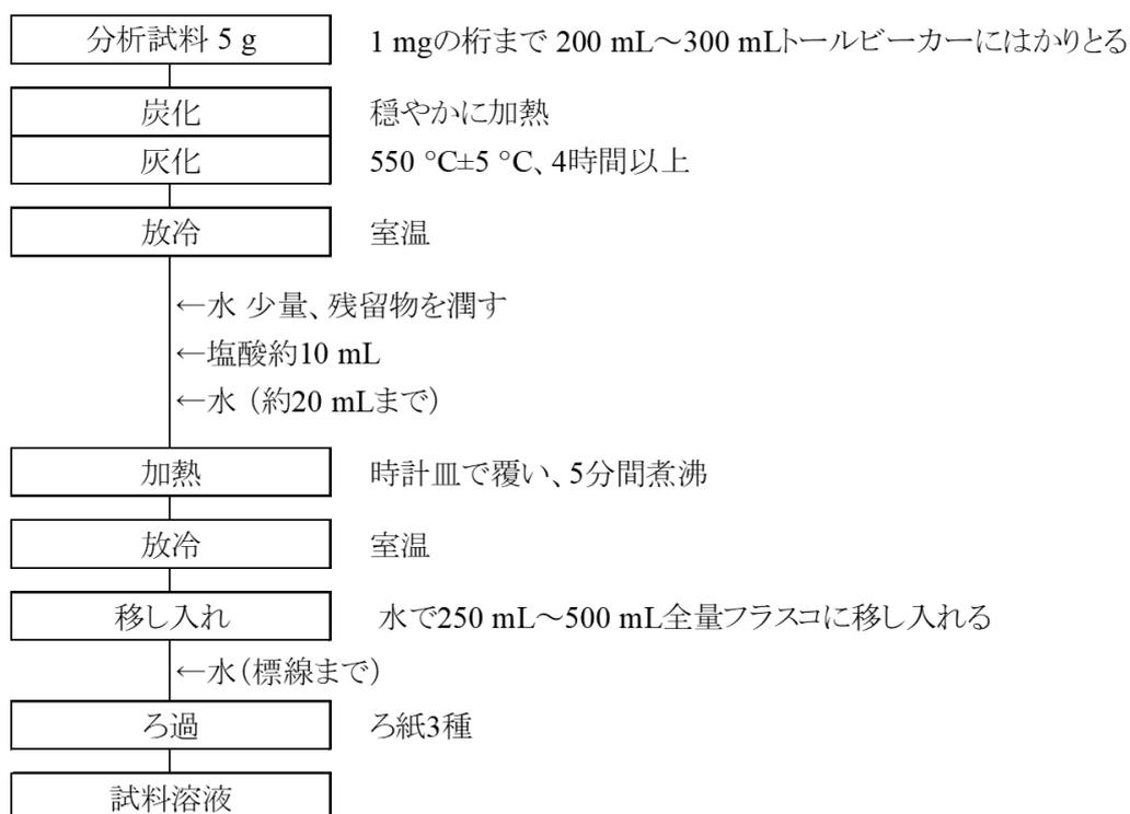
図1 肥料中のナトリウム試験法フローシート(抽出操作)
