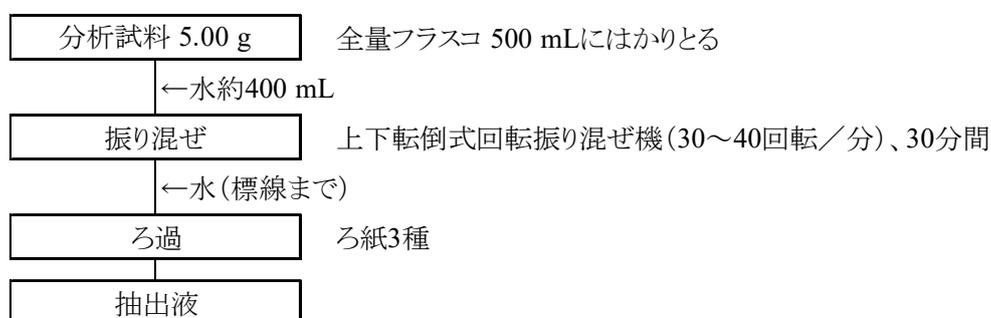
図1-1 尿素性窒素試験法フローシート(抽出操作(4.1.1))
