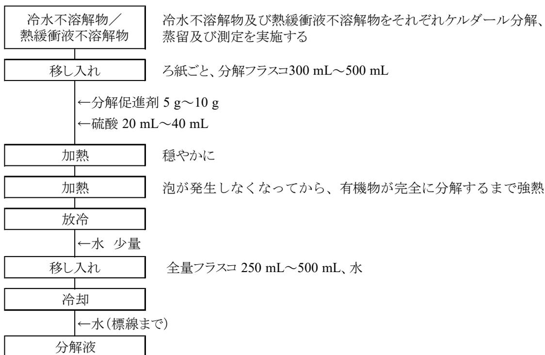
図2 ホルムアルデヒド加工尿素肥料の窒素の活性係数試験法フローシート
