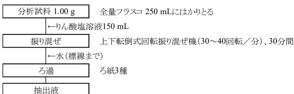
図1 ホルムアルデヒド加工尿素肥料中の冷緩衝液可溶性窒素試験法フローシート
