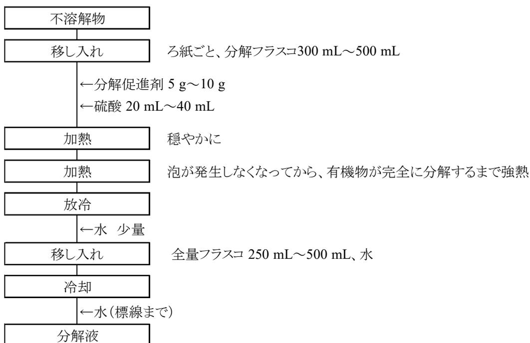
図2 メチロール尿素重合肥料中の熱緩衝液可溶性窒素試験法フローシート
