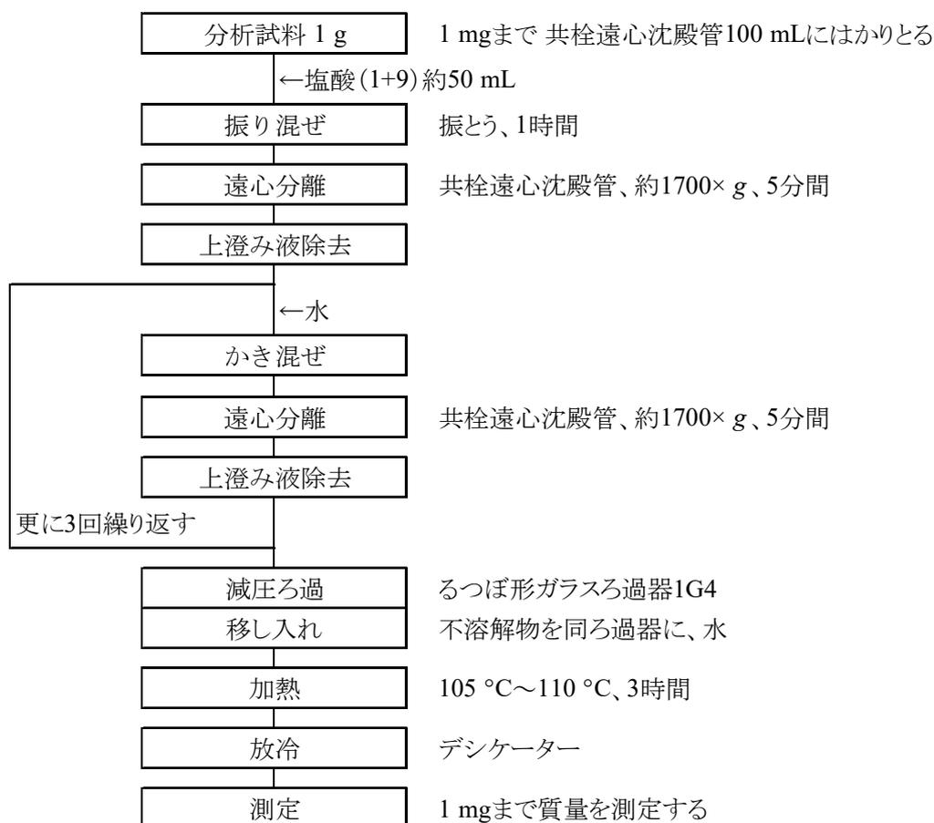
図1 腐植酸塩肥料中の腐植酸試験法フローシート
