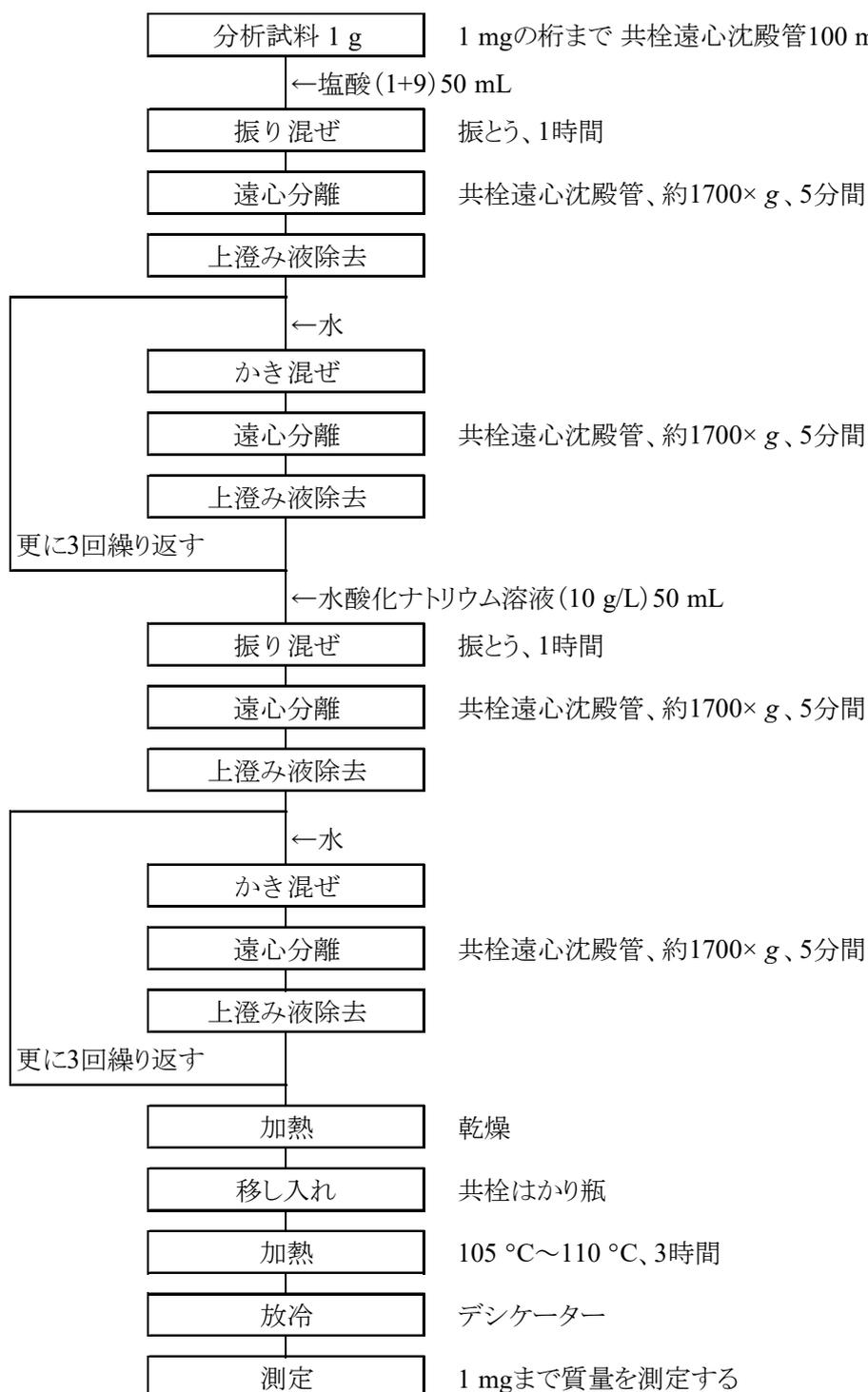
図2 腐植酸塩肥料中の腐植酸試験法フローシート
