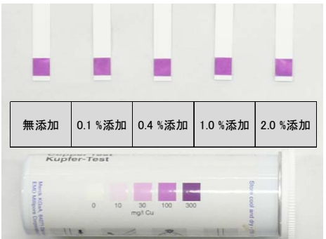
写真 55 0.1 %相当量硝酸銅三水和物溶液への硝酸添加試験結果
