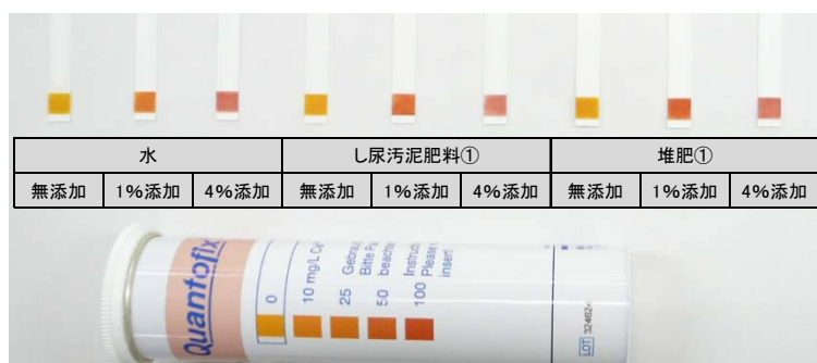
写真2 硝酸カルシウム四水和物の添加試験結果
