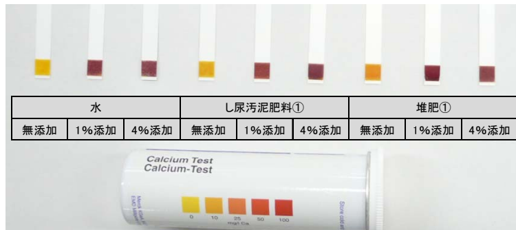
写真1 硝酸カルシウム四水和物の添加試験結果
