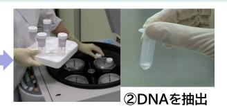
粉砕した試料から、専用の試薬 キットを用いてDNAを抽出・精 製します。含まれているDNAは ごく少量なので、丁寧に作業し ます。
