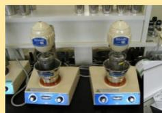
試料に有機溶媒を加えて混合
