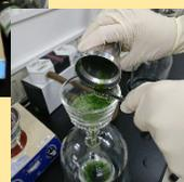
吸引ろ過して試料の残さなどを取り除き、有機溶媒に溶けた成分を回収
