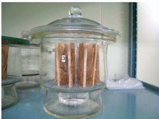
ホルムアルデヒドは水に溶けやすいので、左の写真のようにガラスデシケーターの中に試験片と蒸留水の入ったガラスの器を入れ、試験片から放散するホルムアルデヒドを蒸留水に吸収させます。
