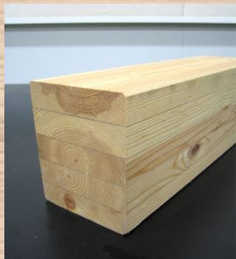
構造用集成材とは、ヤング係数(変形しにくさ)や節(ふし)などの欠点により強度区分した「ラミナ(ひき板)」を、接着剤で積層方向に貼り合わせたものです。
