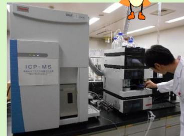
誘導結合プラズマ質量分析装置 (ICP-MS)を用いた肥料及び飼料原料中の金属元素の分析
