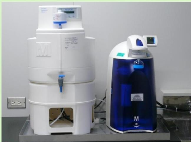
※超純水製造装置は、水道水または純水から有機物や無機物、微粒子、気体などを様々な工程を経て取り除き、非常に純度の高い水(超純水)を精製する機械。
