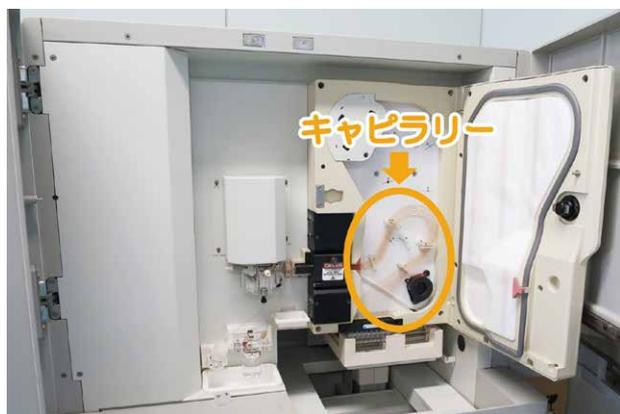
図4 キャピラリー電気泳動装置の内部
