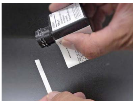
②試験紙に試薬を1滴垂らす
