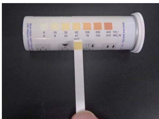
④カラースケールと試験紙の色を比較する
