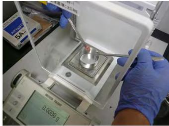
① 薬さじにて乾燥容器内に試料を採取する。
