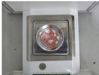
⑤ 試料塊を乾燥容器底面に写真程度に均等に散らせる。
