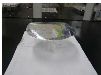
①口を下にしてビーカーを置き、その上に中心を合わせるように円形アルミ箔を置く。
