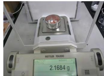
⑥ 試料質量を測定、記録し、このときの質量を $W_1$ とする。
