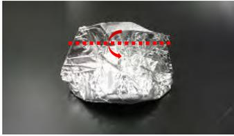
④潰した上端を点線部で折り曲げる。
