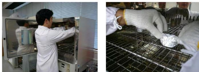
図4 恒温乾燥器内におけるアルミニウム箔カップの密閉操作
