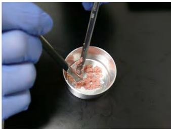
④ 試料塊を薬さじにてほぐす。付着しやすい試料の場合は、薬さじを2本使用する。
