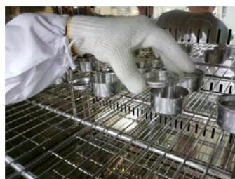
図2 恒温乾燥器内におけるアルミニウム製ひょう量皿のふたを閉める操作
