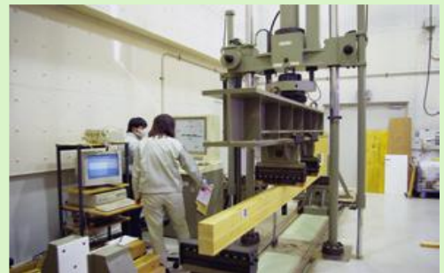
木質建材の品質に関する調査
