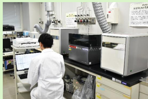
安定同位体比測定装置
