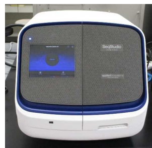
DNAの暗号の並び順を調べる装置(シーケンサー)
